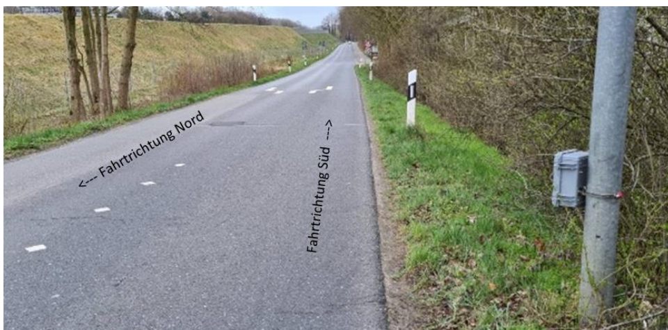
Messstelle B südlich der BAB-Brücke (Verkehrsmengenerfassung und Geschwindigkeitsmessung in beiden Fahrrichtungen)
