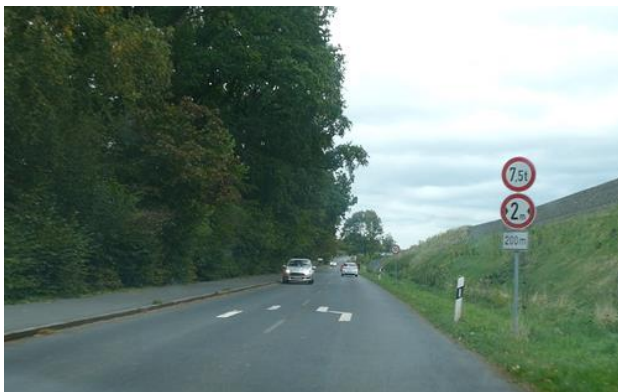
Bodenmarkierung Verengte Fahrbahn, Verbot für Fahrzeuge mit einer tatsächlichen Masse von mehr als 7,5t, Verbot für Fahrzeuge mit einer tatsächlichen Breite von mehr als 2,00 m
